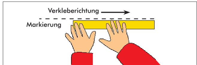
Folie an der Markierung auf der gereinigten Oberfläche ausrichten.
