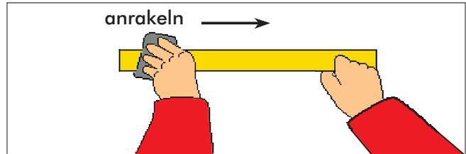
Entfernen sie nun immer schrittweise ca. 50 cm des Kleber- Schutzpapiers und halten mit der einen Hand den Folienstreifen stets straff, während Sie mit der anderen die Konturmarkierung entlang der Markierung Festrakeln.
